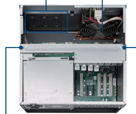
左右两侧各安装一个2.5英寸SSD
