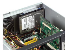
用于容纳内部3.5英寸 硬盘的防震硬盘位
