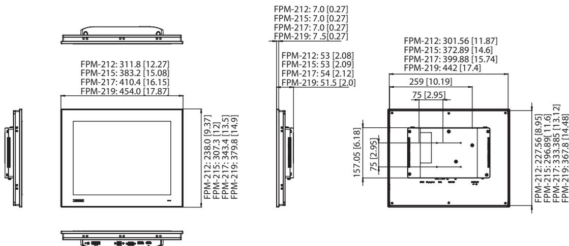
面板开孔尺寸: FPM-212: 303 x 229 毫米 (11.93 x 9.02 英寸)
